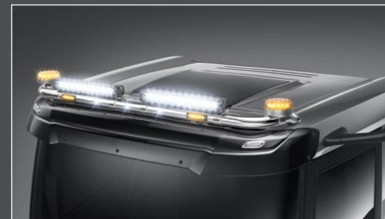
28704-3-P - LightFix - SKY-LIGHT nur für Fahrzeuge mit Sonnenblende Dachlampenbügel für maximal 6 Scheinwerfer und 2 Kennleuchten Edelstahl - hochglanzpoliert - Ø 70mm - mit Kabelsatz
