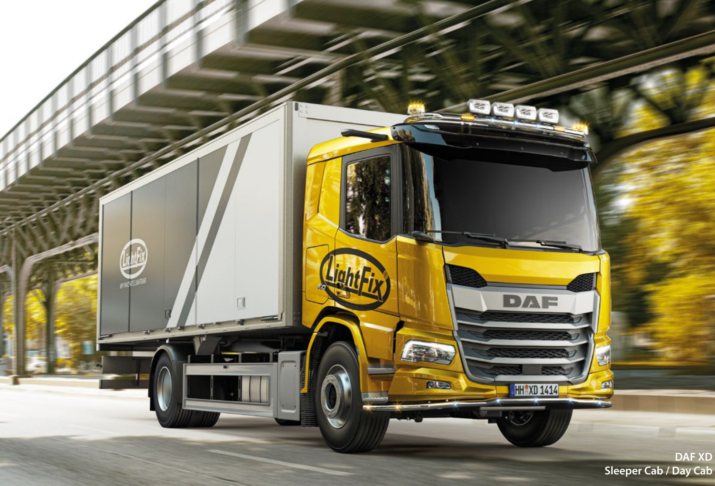
28715-3-P - LightFix - REAR-LIGHT Dachlampenbügel für maximal 4 Arbeitsscheinwerfer und 2 Kennleuchten Edelstahl - hochglanzpoliert - Ø 70mm - mit Kabelsatz
